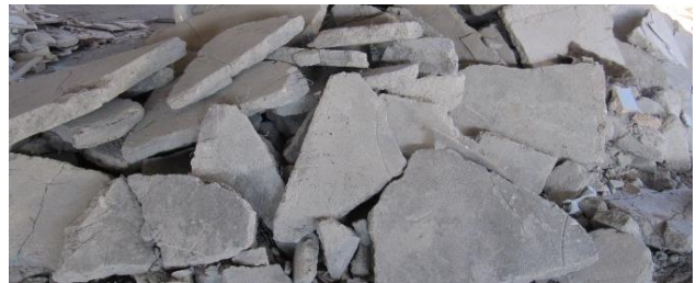
Abb. 12: Selektiv erfasster Estrich [Mettke]
