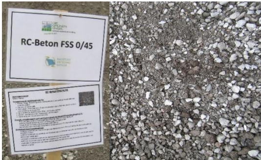
Abb. 1: RC Beton der Fa. DURMIN, gütegesichert und zertifiziert durch Baustoff Recycling Bayern e.V. [Mettke]
