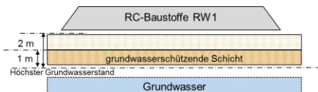
Abb. 29: Eingeschränkter offener Einbau (RW1) 24 [Mettke]
