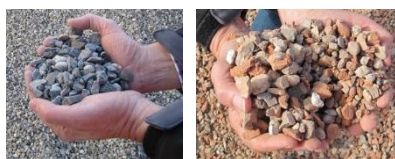
Abb. 31: Typ 1 / Betonsplitt; Typ 2 / Bauwerksplitt [Mettke]
