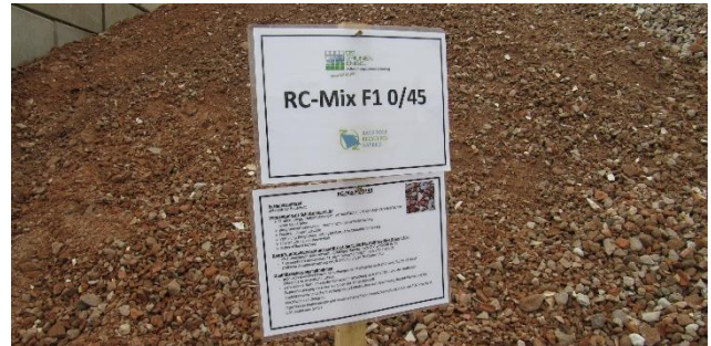
Abb. 2: RC Mix der Fa. DURMIN, gütegesichert und zertifiziert durch Baustoff Recycling Bayern e.V. [Mettke]
